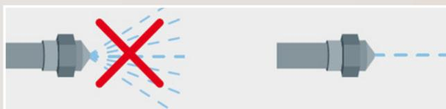
Ne pas vaporiser, mais pulvériser moyennant des buses coniques de 1 mm sans diffuseur, pour obtenir des gouttelettes d'environ au moins 4 mm
